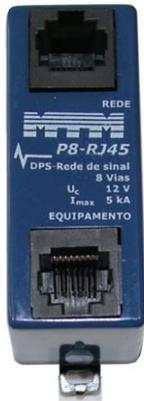
O DPS **P8-RJ45** destina-se à proteção de equipamentos da tecnologia da informação - ETI, conectados as redes de dados com 8 vias de comunicação, ou, qualquer equipamento que utilize conectores RJ-45 com ou sem blindagem e taxa de transmissão inferior a 1G.
